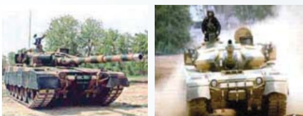
Char pakistanais Al Khalid, qui ne peut cacher sa filiation avec le T-64 / 72, avec lequel il partage le canon de 125 mm
