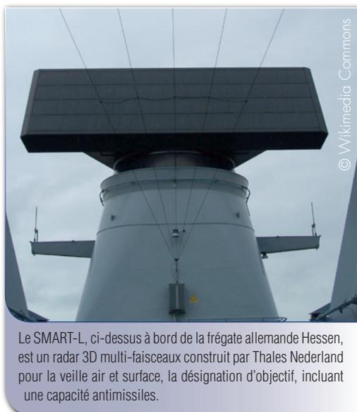
Le SMART-L, ci-dessus à bord de la frégate allemande Hessen, est un radar 3D multi-faisceaux construit par Thales Nederland pour la veille air et surface, la désignation d'objectif, incluant une capacité antimissiles.
