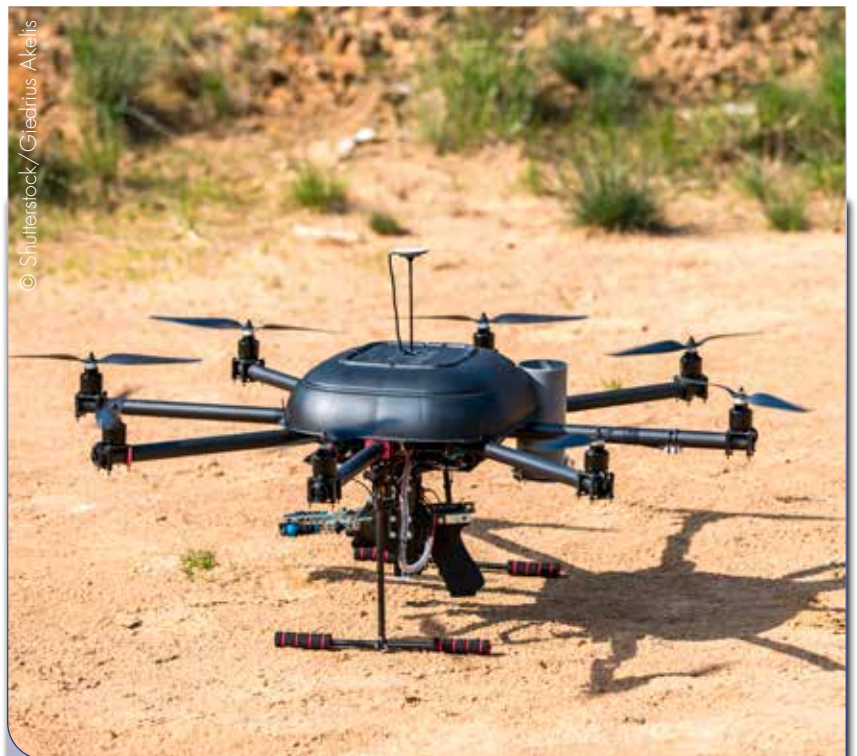
Un drones octocoptère équipé d'une arme à feu. Adapter de petits équipements issus du commerce pose une vraie difficulté tactique à l'adversaire pour un coût réduit.
