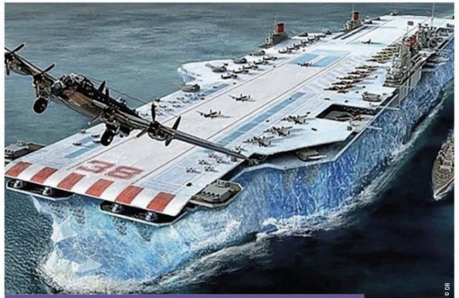
Le porte-avions Habakkuk de plus de 600 m de long fut imaginé par l'Amirauté britannique en 1942, utilisant un mélange de glace et de sciure de bois pour constituer une structure incassable. Mais les performances croissantes des avions anti-sous-marins mirent fin à cet extravagant projet.
